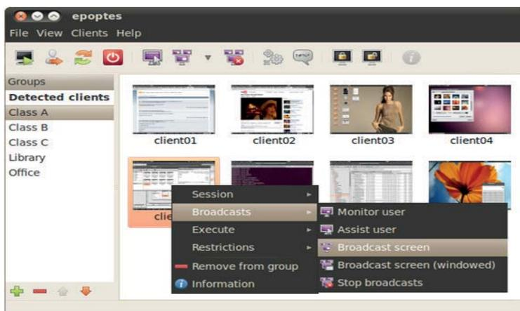
**Εικόνα 10.8.** eroptes, εφαρμογή για απομακρυσμένο έλεγχο των υπολογιστών
